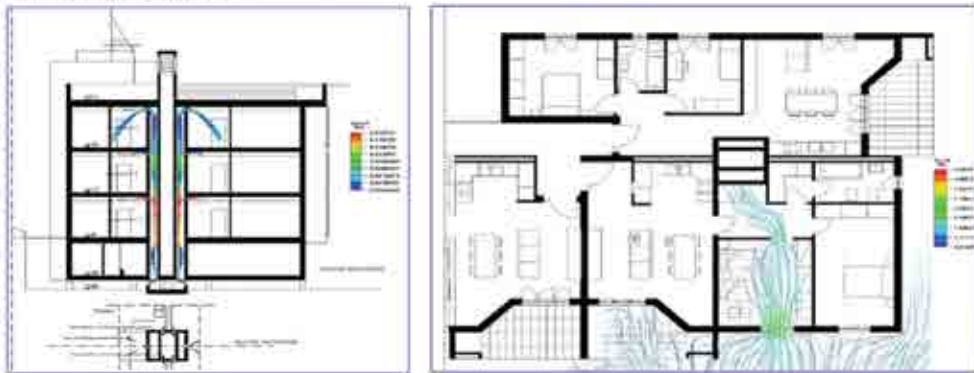
Comportamento delle Torri di Ventilazione e scambio d'aria con le singole unità abitative
