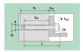
diametro barra L lunghezza barra spessore fissabile  $t_{fix}$  $d_0$ diametro foro profondità min. foro  $h_1$ profondità di inserimento  $h_{nom} =$
