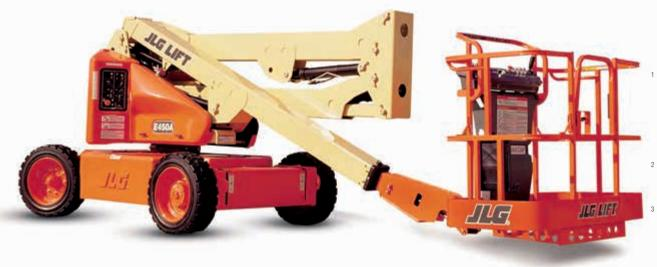
Pilota spie luminose sulla console di comando della piattaforma per anomalie sistema, batteria scarica, spia inclinazione e stato interruttore a pedale. Comprende allarme movimenti e lampeggiante arancione. Comprende fari di testa e di coda e fari da lavoro su piattaforma.
