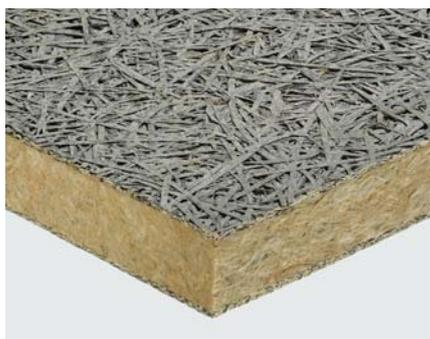
Pannello isolante termico ed acustico composito, costituito da due strati (spessore 5 mm ciascuno) in lana di legno di abete rosso mineralizzata e legata con cemento Portland grigio, accoppiato ad uno strato interno di lana di roccia ad alta densità, conforme alla norma UNI EN 13162.
