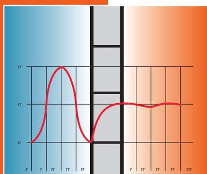
*Andamento delle temperature esterne ed interne per un involucro massivo. L'onda termica viene sia attenuata che sfasata in base alla massa della parete.*
