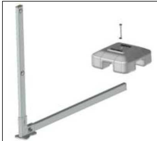
Figura 4: Posa dei contrappesi
