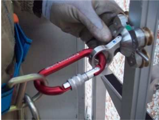
Carrello inserito correttamente (al centro a destra lo spinotto che impedisce l'inserimento scorretto; il lato superiore bollino verde)
