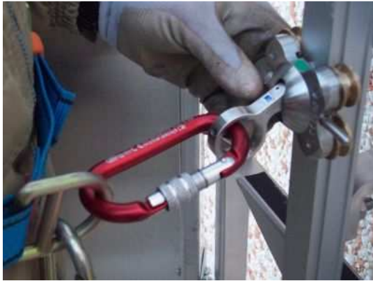
Carrello inserito correttamente (al centro a destra lo spinotto che impedisce l'inserimento scorretto; il alto al centro bollino verde)
