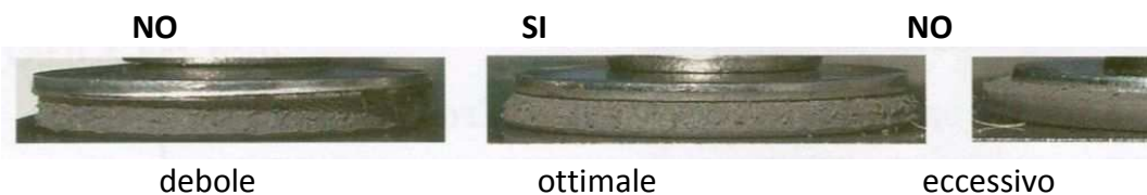
Figura 11: serraggio della rondella con guarnizione
