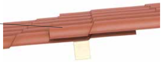
Installazione con due file di lastre sovrapposte per falda Installation using two rows of overlapping sheets
