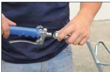
1. Avvitare l'impugnatura al dispositivo saldagiunte
