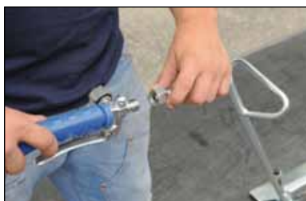
Togliendo il dispositivo saldagiunte è possibile applicare una lancia all'impugnatura ottenendo un cannello tradizionale
