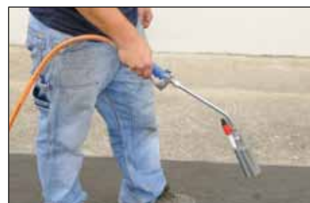
Togliendo il dispositivo saldagiunte è possibile applicare una lancia all'impugnatura ottenendo un cannello tradizionale
