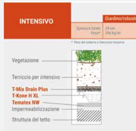
Indipendentemente dalla stratigrafia utilizzata, è fondamentale proteggere l'integrità del sistema di impermeabilizzazione con il geotessile Tematex NW, che deve essere resistente alle radici delle piante per evitare danni. Inoltre, è importante che la copertura, sebbene sia considerata "piana", abbia una pendenza minima per il corretto drenaggio delle acque meteoriche verso gli scarichi.
