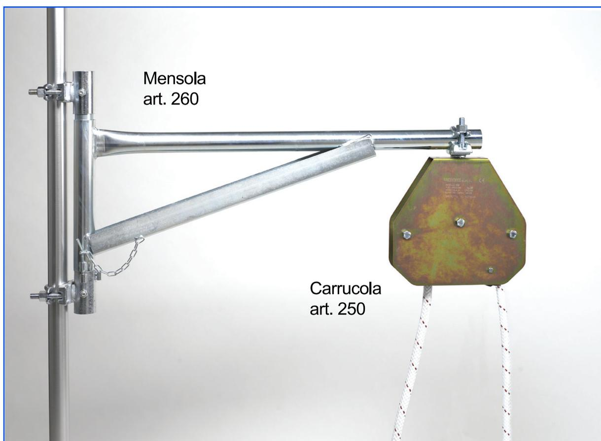
La carrucola di sicurezza **art 250** azionata a mano, con **sistema di frenatura brevettato**, è particolarmente indicata per l'utilizzo nel montaggio e nello smontaggio di ponteggi. Essa può essere fornita singolarmente con manicotto di fissaggio, o con mensola girevole di sostegno (**art 260**).
