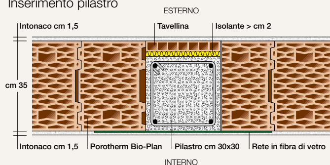
Porotherm Bio-Plan 35 Inserimento pilastro
