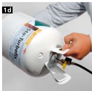
1e Agitare la bombola Sto-Turbofix Prima di iniziare l'applicazione prendere la bombola ed agitarla energicamente per almeno 20 volte in modo da mescolare la schiuma collante PUR assicurandone una qualità eccellente.
