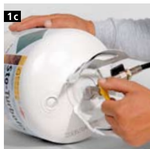
1d Aprire la bombola Sto-Turbofix Aprire lentamente il rubinetto (valvola) posto in cima alla bombola e verificare se l'intera attrezzatura Sto-Turbofix è priva di perdite. Se non ne vengono riscontrate, l'impianto Sto-Turbofix è pronto all'uso.
