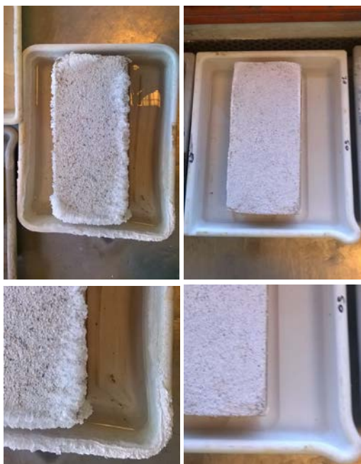
Intonaco deumidificante "standard" dopo la prova RILEM MS-A 2
