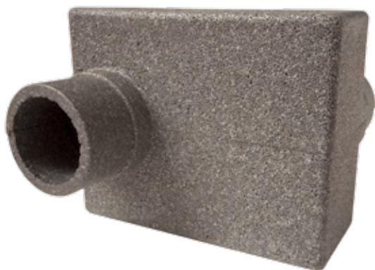
Silenziatore acustico in polipropilene espanso poroso (P-EPP) ad elevato potere fonoassorbente e bassa conducibilità termica. Le proprietà fonoassorbenti del P-EPP garantiscono elevate prestazioni senza l'utilizzo di materiali fibrosi e/o spugnosi destinati a degradarsi nel tempo e che potrebbero compromettere la qualità dell'aria. Garantisce una sezione di passaggio del flusso d'aria di 100 cm<sup>2</sup>. Il prodotto è simmetrico (può essere posato in entrambi i versi). Griglie non incluse.
