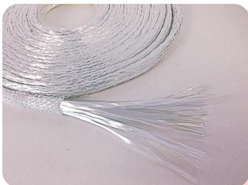
**OLY ROPE GLASS** è un elemento strutturale a sezione circolare in vetro costituito da filamenti monodirezionali di vetro che vengono messi insieme a costituire un "trefolo"; è ampiamente utilizzato nel consolidamento di strutture di edilizia, sia nuova che storico-monumentale, per la realizzazione di chiodature armate, catene, rinforzo intradossale di volte, rinforzo di murature o ancoraggi sulle murature.
