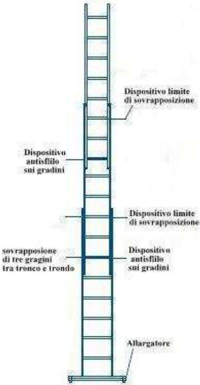
Il diagramma illustra la struttura di una scala a sfilo. È composta da un tronco principale e un tronco intermedio. Sono evidenziati i dispositivi di sicurezza: un "Dispositivo antisfilo sui gradini" e un "Dispositivo limite di sovrapposizione" in due punti. La "sovrapposizione di tre gradini tra tronco e tronco" è chiaramente visibile. All'angolo inferiore della scala è presente l'"Allargatore".
