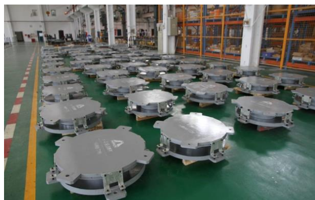
Immagine 29: Isolatori a singola e doppia superficie di scorrimento Hislide HP1 – HP2.
