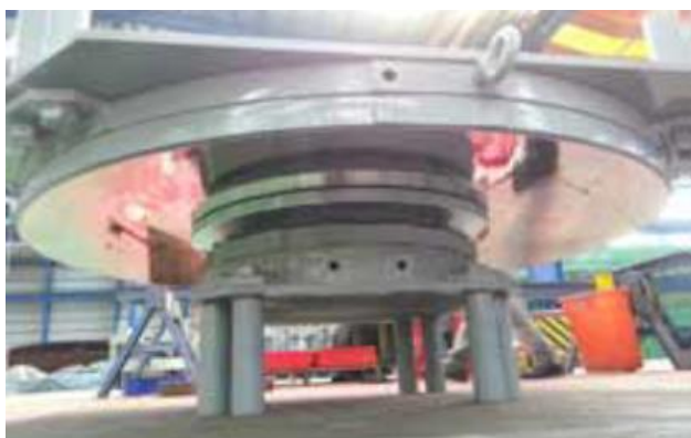
Immagine 29: Isolatori a singola e doppia superficie di scorrimento Hislide HP1 – HP2.
